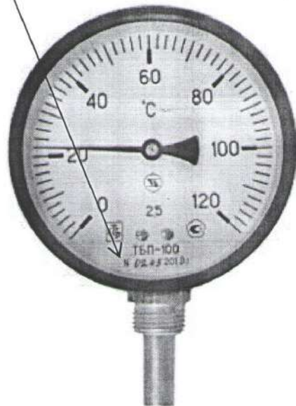
Рисунок А.4 – Термометр биметаллический показывающий ТБП100 (исполнение 3)
