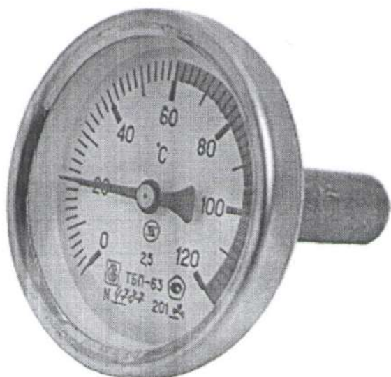
Рисунок 1 – Термометр биметаллический показывающий ТБП63 (исполнение 1)
